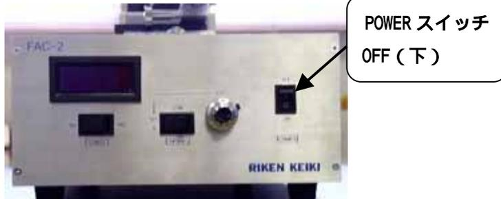
電源ケーブルを取り付け AC 100V 50/60Hz のコンセントに差し込んで下さい。
